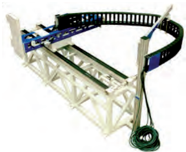
x-y-z-Bewegungssystem für vollautomatische Verklebeprozesse | x-y-z-motive system for full automatic glueing processes
